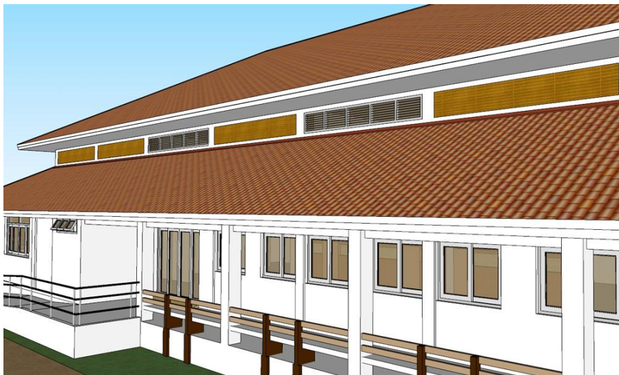
รูปที่ 5.8 ช่องแสงบานเกล็ดติดตายบริเวณผนังระหว่างหลังคาซ้อน
